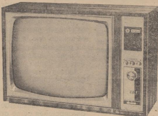
Una de sus revolucionarias novedades es la utilización de transistores en el selector de canales y en el sintonizador de UHF, que ofrece las siguientes ventajas sobre el sistema de válvulas: 1.º, vida más larga; 2.º, eliminación total de microfonsismos; 3.º, notables mejoras en la sensibilidad y en la definición de imagen.
