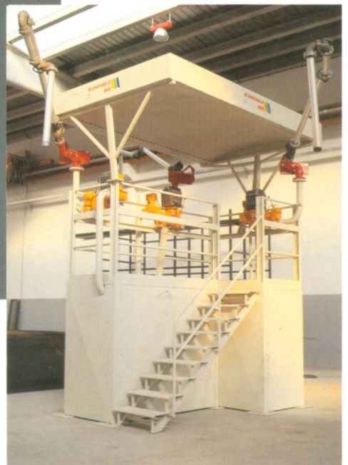
Planta prefabricada per a càrrega, amb comptador, simultània per a tres camions-cisterna. (Disseny Baseiria Oil).
