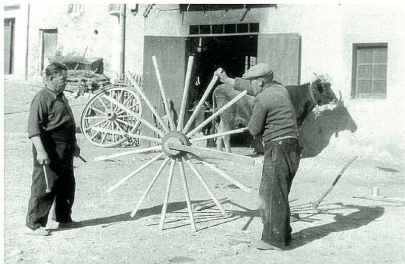
Construcció artesanal d'una roda a càrrec del carreter i el ferrer del poble. Anys cinquanta.
