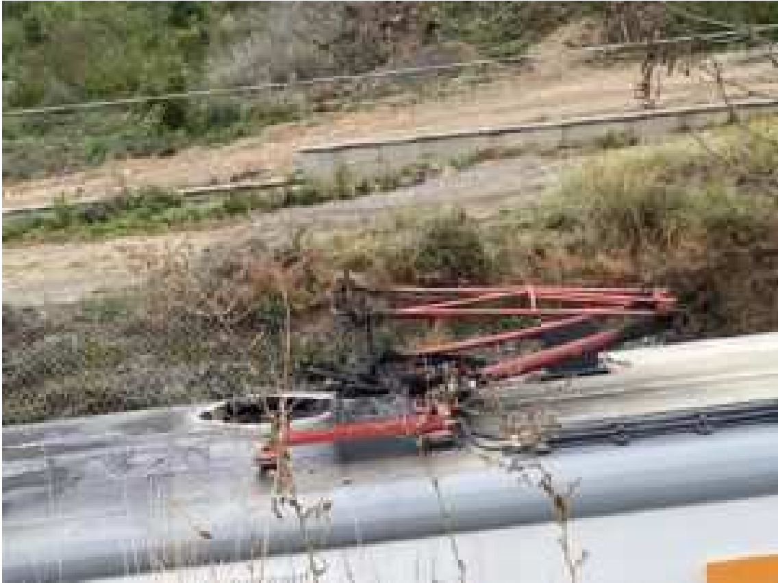
Estat del sostre del vagó afectat per l'incendi un cop extingit pels bombers./N.B.
