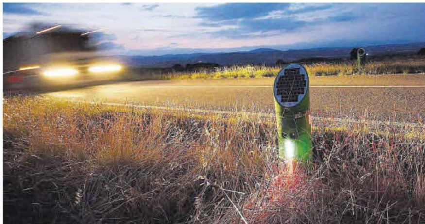
Una de les balises que emeten llum i sons per foragitar la fauna salvatge als trams de més accidents
