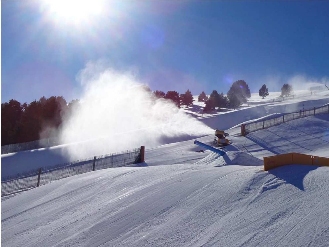
Canó de neu tipus ventilador als Alabaus de La Molina (Foto: arxiu DDLN).
