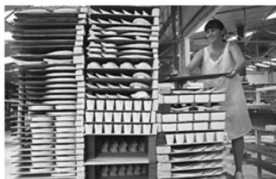
► Una fornada de 1.400 graus. Les peces de porcellana que es fabriquen a Pordamsa passen per una fornada de 1.400 graus centígrads, una escalfor que dona la màxima garantia i qualitat al producte, que, malgrat la utilització constant, no es degradarà. / LL. SERRAT
