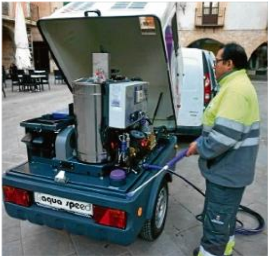
La màquina llevaxiclets funciona amb aigua calenta a pressió.
