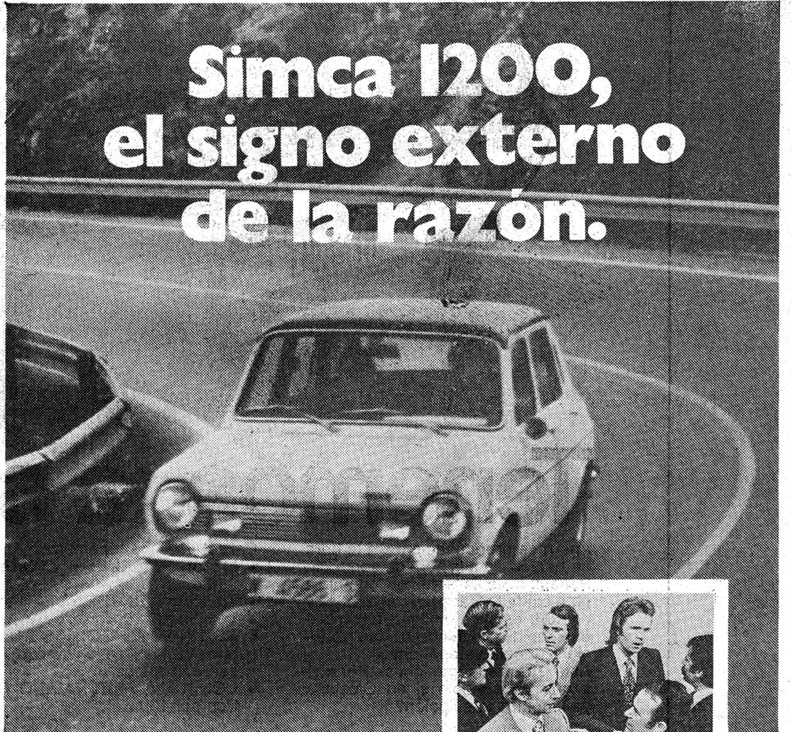
Los SIMCA 1200 están hechos para la eficacia. Por eso tienen dirección de cremallera con junta cardán y flector, suspensión independiente a las cuatro ruedas por barras de torsión y estabilizadoras, tracción delantera, motor transversal de alta compresión, dos circuitos de frenos independientes, frenos de disco y servofreno.
